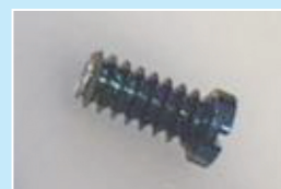
加熱不均導致螺絲尾段色澤較淺
