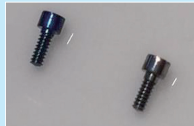
成功烤藍 (左) 與過度加熱而變成淺藍色 (右) 的螺絲
